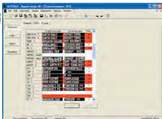
Пример экрана программного обеспечения SFT2841: матрица управления
