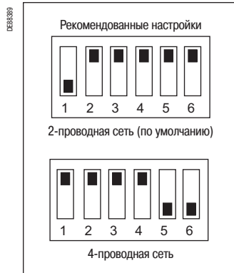
Настройка сети RS485
