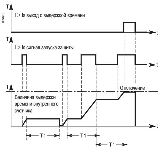
Обнаружение перемежающихся замыканий с помощью регулируемого времени удержания.
