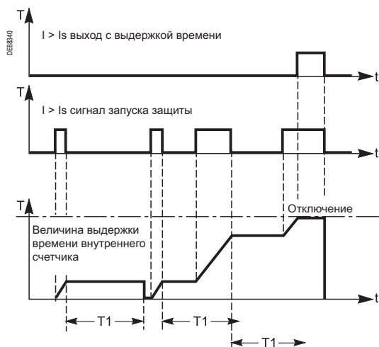
Обнаружение перемежающихся замыканий с помощью регулируемого времени удержания
