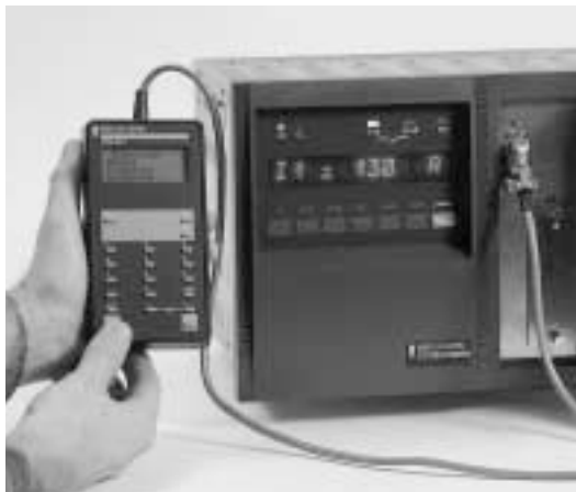
Результаты измерения отображаются на индикаторе Sepam и на пульте TSM 2001.
