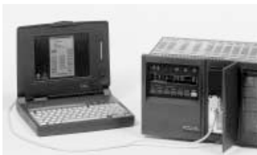
Адаптер ACE 900, подключаемый к разъему пульта.
