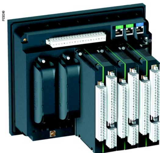
Максимальная конфигурация Sepam серии 80 с 3 модулями MES 120: 42 входа и 23 выхода
