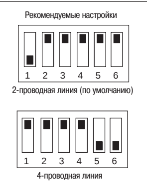
Параметрирование линии связи RS 485
