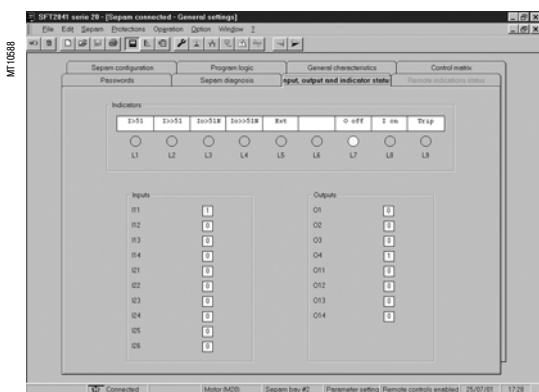
Экран "Состояние входов, выходов, сигнальных ламп"
